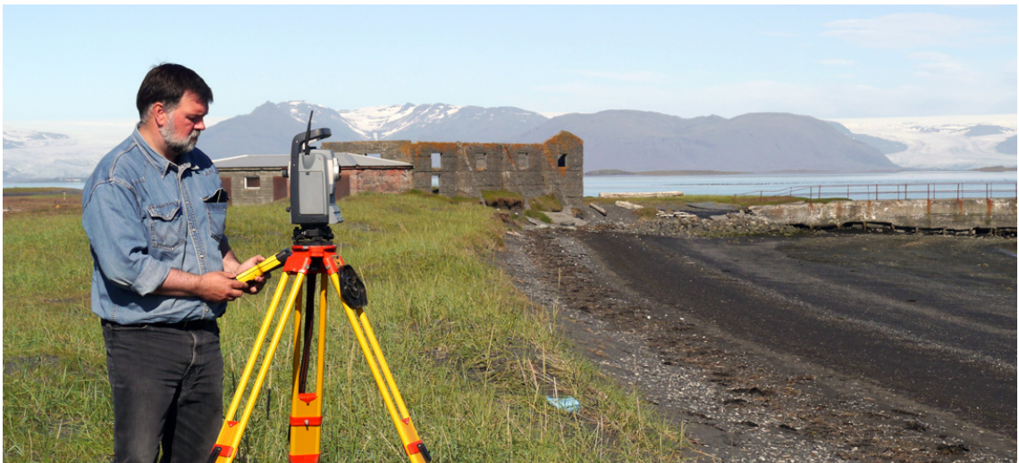
Hæðarmæling yfir Hornafjarðarós vegna hæðarákvörðunar á sjávarhæðamæli í Hvanney
